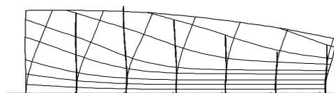
図9 新展開法による曲面外板の展開図
