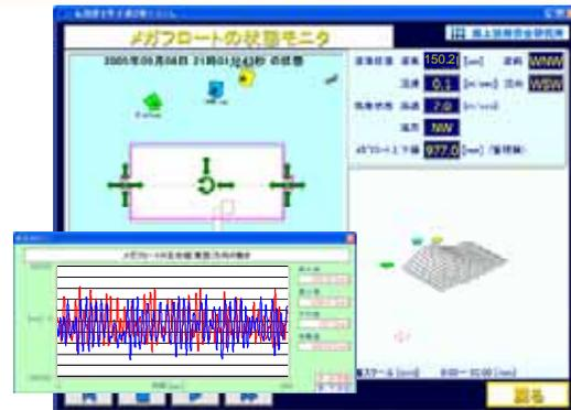
メガフロートの状態表示(3次元弾性変形図、計測データ表示)
