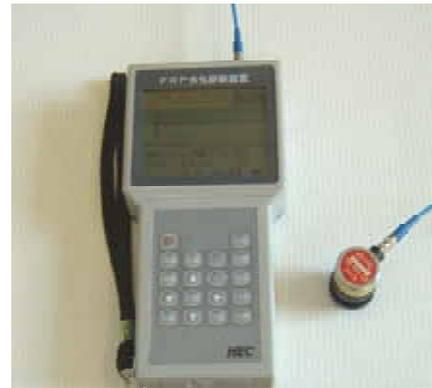
図17 FRP劣化診断装置
