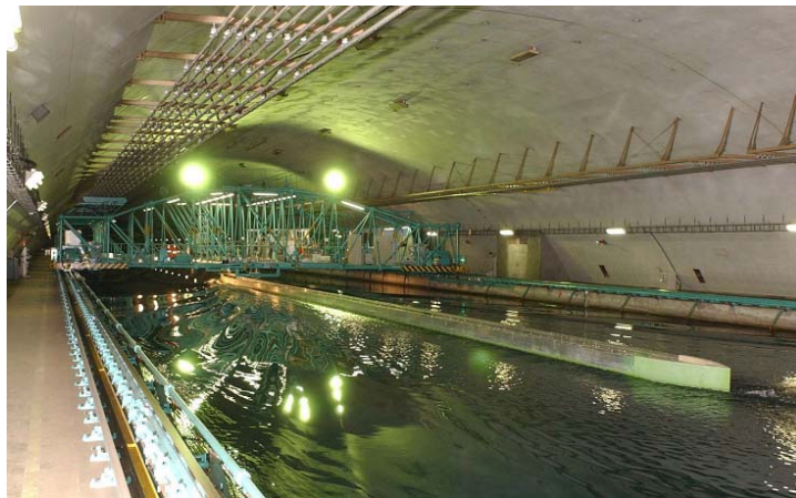
50m長尺平板模型試験による空気潤滑試験
