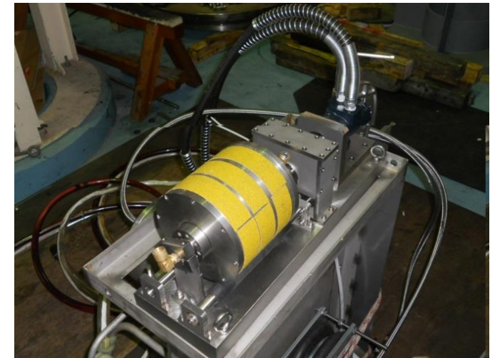
水中用ボールミル試験装置
