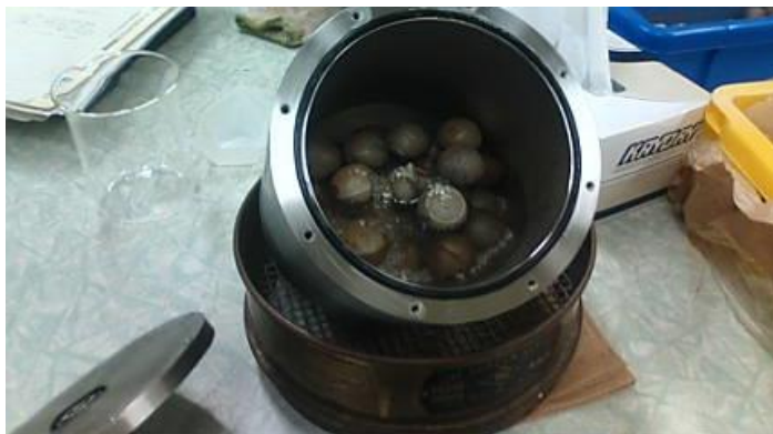
ミルポットへの珪砂と鋼球の充填
