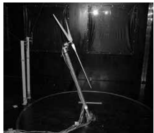
写真-1 風車模型の風洞試験
