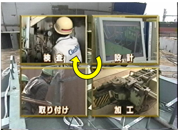
図1 配管艤装の流れ
