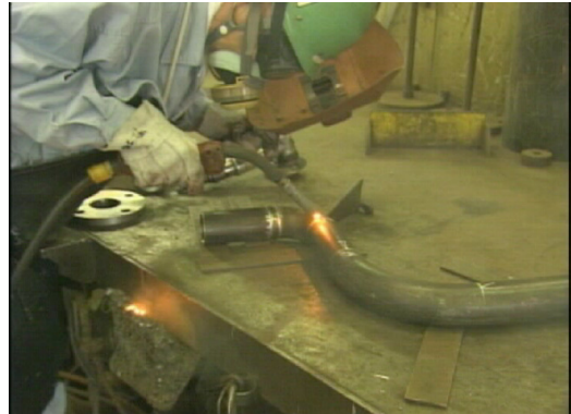
図7 溶接による組立
