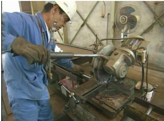
図5 丸鋸による切断作業
