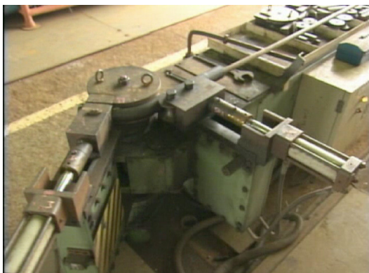
図6 パイプベンダによる曲げ加工
