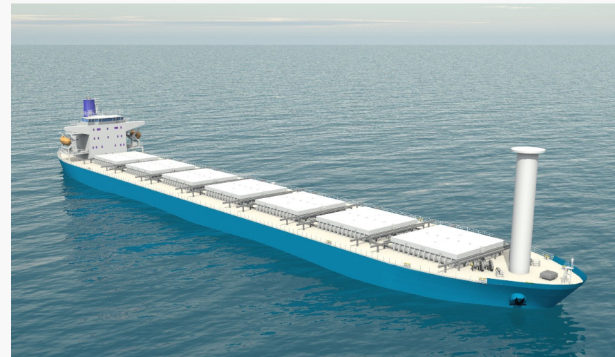
ローター設置位置：ミッドシップより45% L_{PP} 前方 センターライン上
