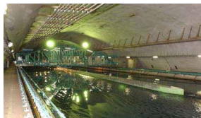
400m水槽で50m平板模型船を7m/sで曳航中
