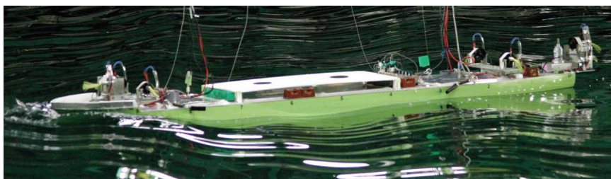
風荷重模擬装置と補助推力装置を用いた自由航走試験による波・風併存時の実船性能の直接推定
