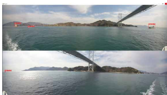
自動避航のためのマシンビジョン。 認識した他船をタグ表示している。
