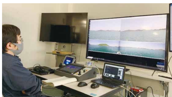
遠隔操船の様子。 東京の研究所から瀬戸内海の実験船「神峰」を操船している。
