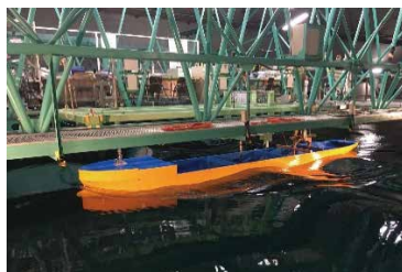
波浪中水槽試験・CFD計算
