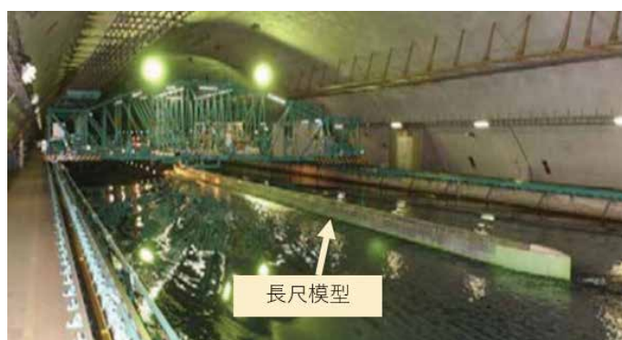
36m 長尺模型実験 (400m 水槽)
