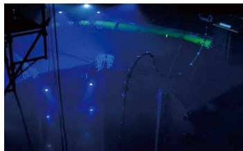
内部流を伴う移送管の水槽試験の様子
