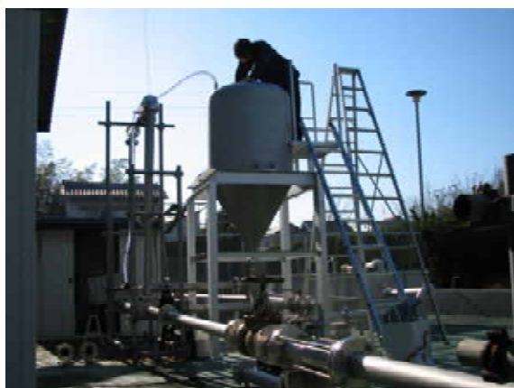
図1.43 配管減肉促進実験装置
