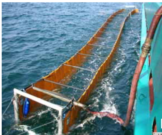
図3.32 深海を模擬した腐食試験の外観
