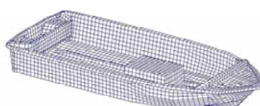
図1.162 船体フレームモデル
