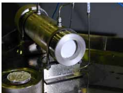
図1.163 生成した高純度メタンハイドレートサンプル
