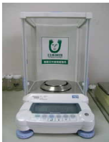
図3.51 水系防汚塗料のVOC測定を可能にした1ツール、精密天秤
