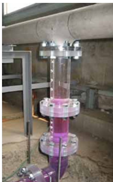
図1.55 流力振動実験結果（円管を2本挿入した場合）
