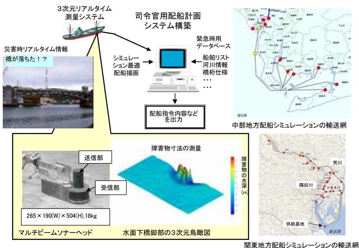
図1.127 司令官用配船計画システムの概念図
