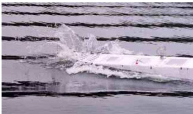
図1.17 自航式模型を用いたフレアスラミングによる衝撃圧の計測
