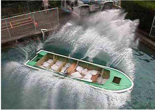
図 3.2.1.16 ブロック接合船の落下試験
