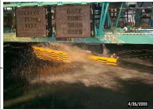
図1.24 波浪中模型実験
