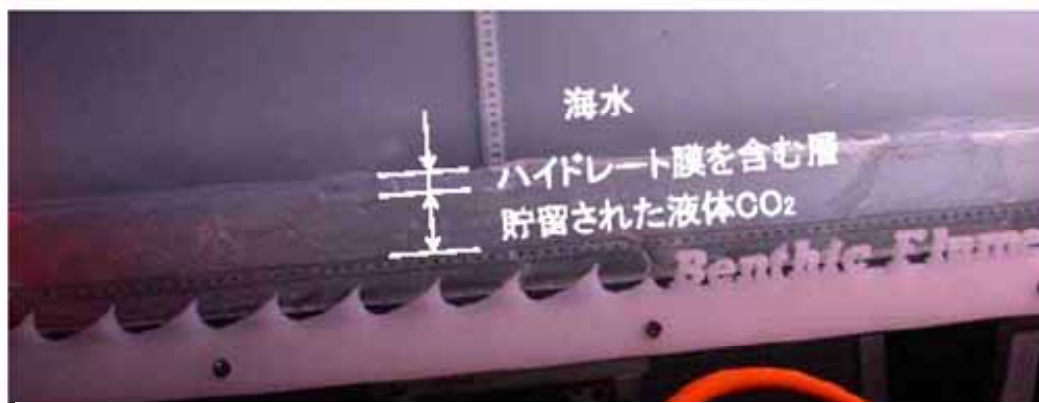
図2.10 深度4,000mにおけるCO 2 貯留実験の様子
