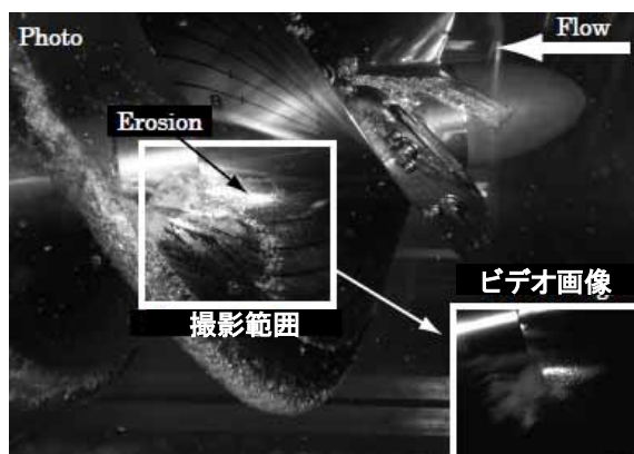
図1.98 超高速度ビデオによるキャビティ崩壊現象の把握
