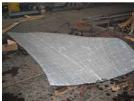
図1.136 曲率線展開によるS字のねじれ外板施工
