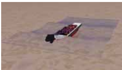
図1.33 CIP法による波浪中船体運動の計算例
