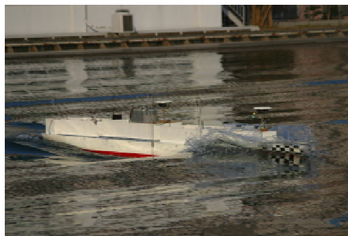
図1.66 改良船型を用いた 波浪中実証実験(80m角水槽)
