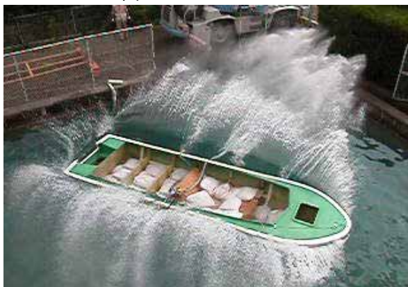
図3.41 ブロック接合船の落下試験
