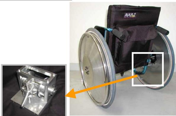
図 1：変速機構付手動車いすと変速機の模型
