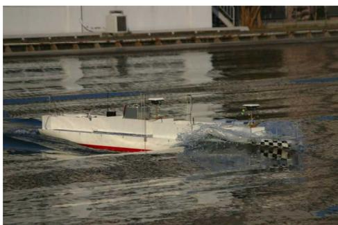
図5: 改良船型を用いた波浪中実証実験 (80m角水槽)
