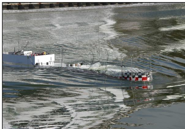
図2：大型ばら積み船を用いた波浪中航走試験
