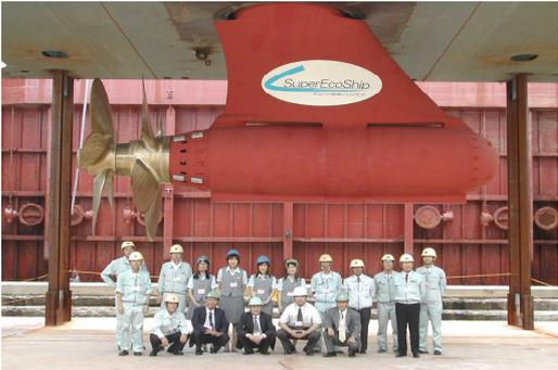
図1：二重反転プロペラ型ポッド推進器
