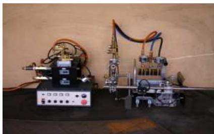
図2：撓鉄簡易自動機
