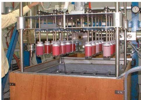
図1：溶出試験装置本体
