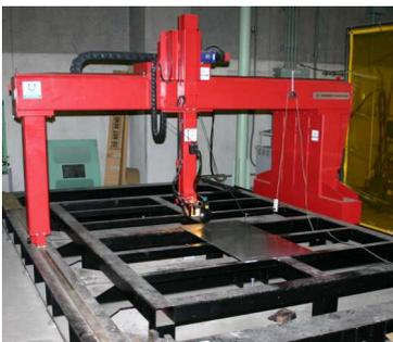
図1：三次元形状計測装置
