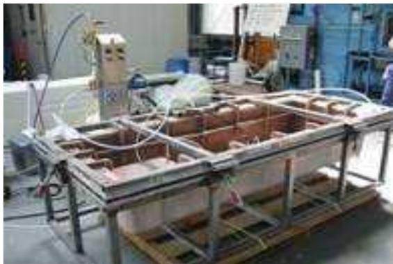
図3.4：LRTM成形法の実験
