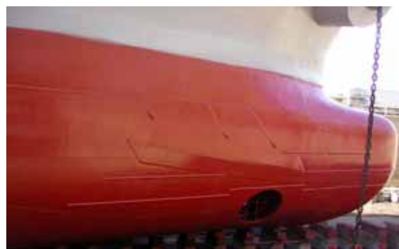
図2: 船首部の気泡吹き出し部
