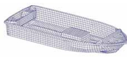
図3: 船体フレームモデル
