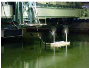
図1: 規則波中動揺試験
