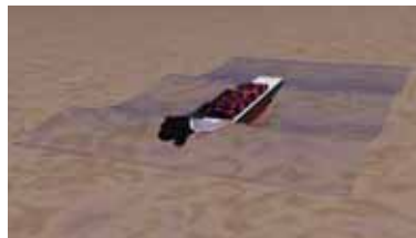
図2.3: CIP法による波浪中船体運動の計算例
