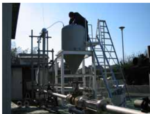
図2: 配管減肉促進実験装置
