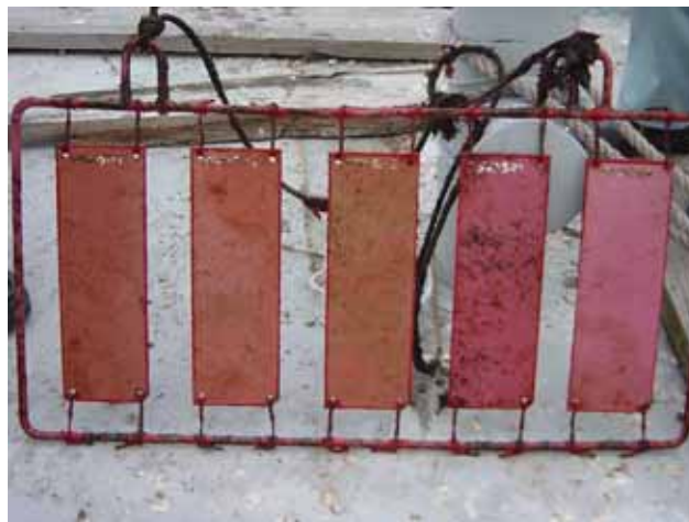
図2: 開発防汚塗料等の実海域暴露試験後の塗膜表面 宮島沖における3ヶ月経過後の写真
