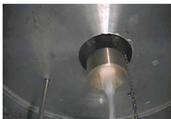
図2：CO 2 スラリー投入の様子 （白く見えるのが氷膜に被覆されたCO 2 スラリー）
