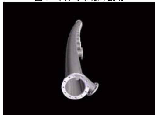
図8 多枝管の溶接変形
