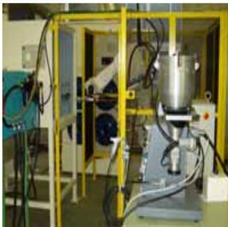
ロボットを装備した溶射装置
