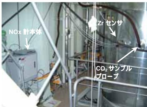
図 1 実船機関室に設置した排ガス計測機器
