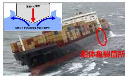
スラミング現象の原理と MSCNapoli 船体折損事故(H19.1)
