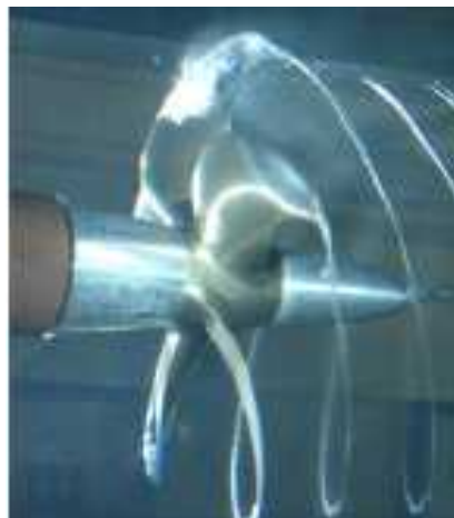
キャビテーションタンクでキャビテーション 壊食の迅速試験を実施中の模型溶射プロペラ。
