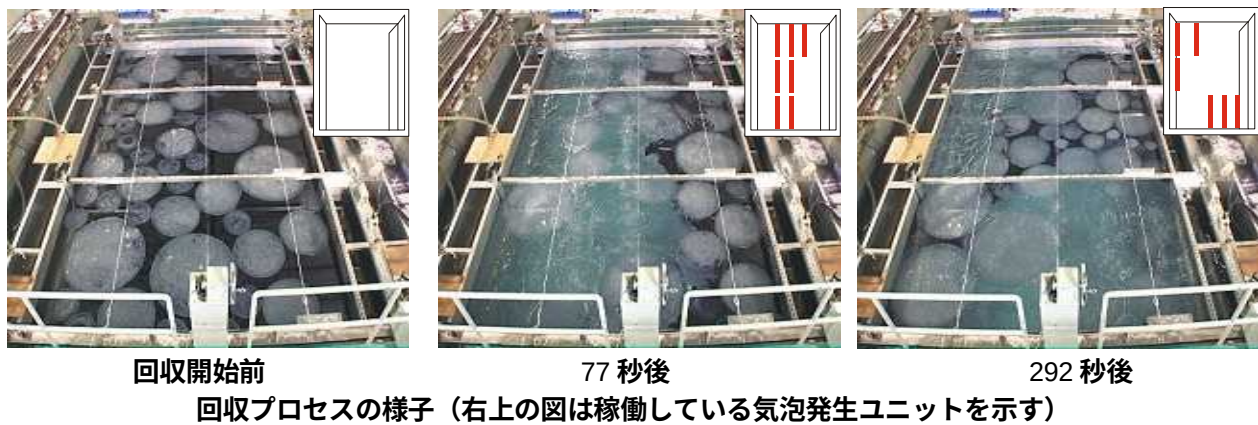
NMRI-ORDICE 水槽実験用模型
