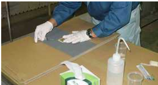
Bresle Patch 法による塩分計測
