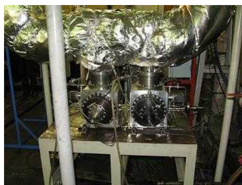
図 2. 5. 11 スターリングエンジンを用いた船舶用低温排熱回収システム
