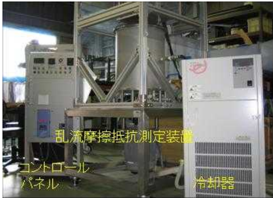
図 1 摩擦力を高精度に測定可能な二重円筒試験装置
