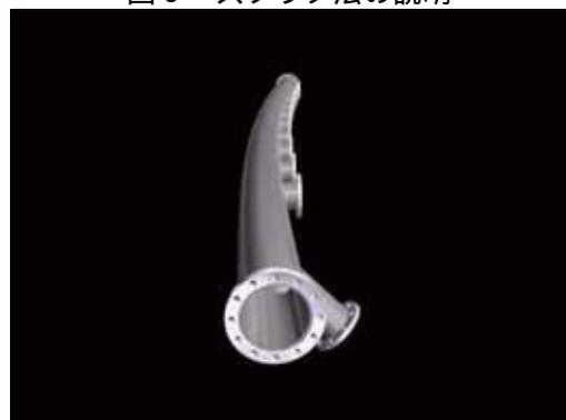
図8 多枝管の溶接変形
