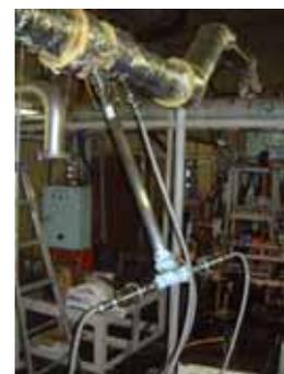
図 2 実験機関の排気管に取付けられた分流希釈トンネル
