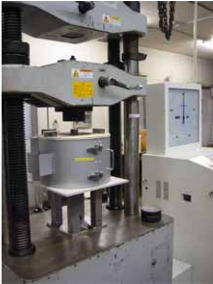
新規の押出加工装置
