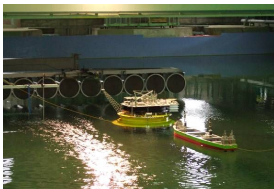
図-3 DP オペレーション検証試験の様子
