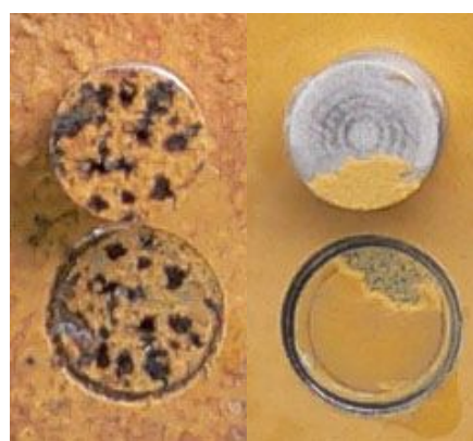
劣化促進試験 6 ヶ月経過の試験片の付着力試験結果 ・ 高温高湿試験（左写真）は乾湿交番試験（写真右）と比べ明らかに劣化が早い
