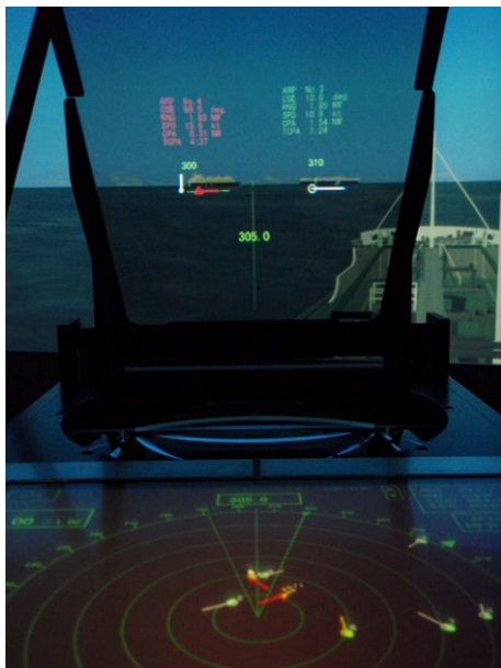
Fig.3 目視認識支援装置の情報表示の様子 赤い表示が警報対象船
