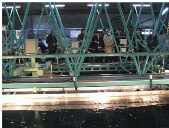
図2. 5. 7 50m長尺模型船による空気潤滑法の抵抗低減試験
