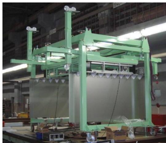
図2 高精度塗膜摩擦抵抗計測装置 (2枚の平行平板の抵抗差を測定することにより高精度で摩擦抵抗が計測できる)
