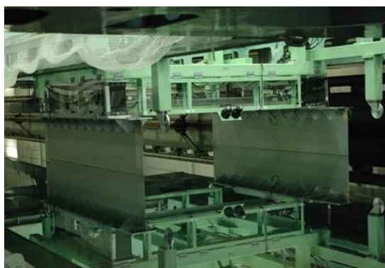
図3 高精度塗膜摩擦抵抗計測装置の水槽実験
