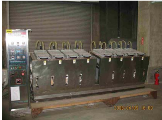
バラストタンク用塗料性能評価試験
