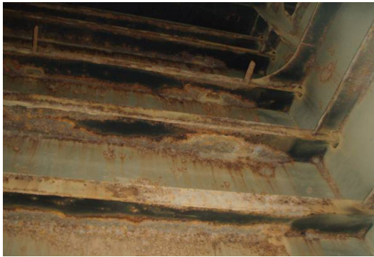
二重船側内の著しい発錆の様子
