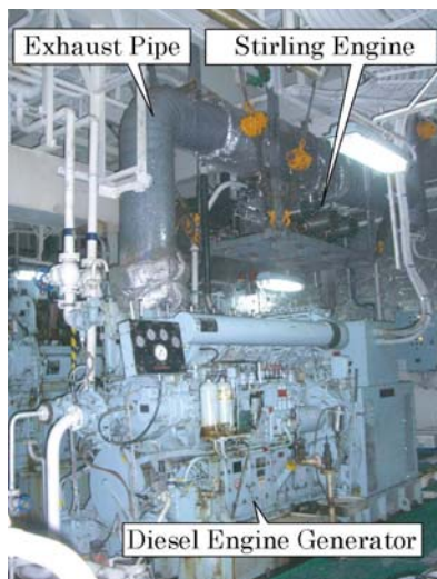
船舶に搭載したスターリングエンジン
