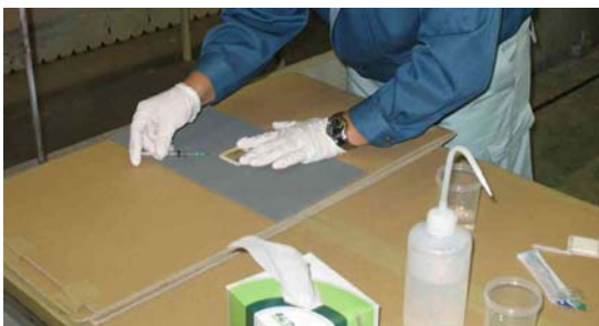
Bresle Patch 法による塩分計測
