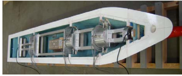
本研究で開発した弾性応答計測システム（ポストパナマックスコンテナ船）
