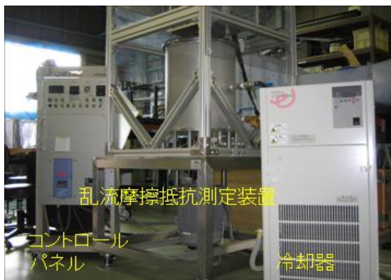
図1 摩擦力を高精度に測定可能な二重円筒試験装置
