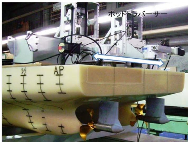
図4 トラバーサによるポッド推進器最適位置調査
