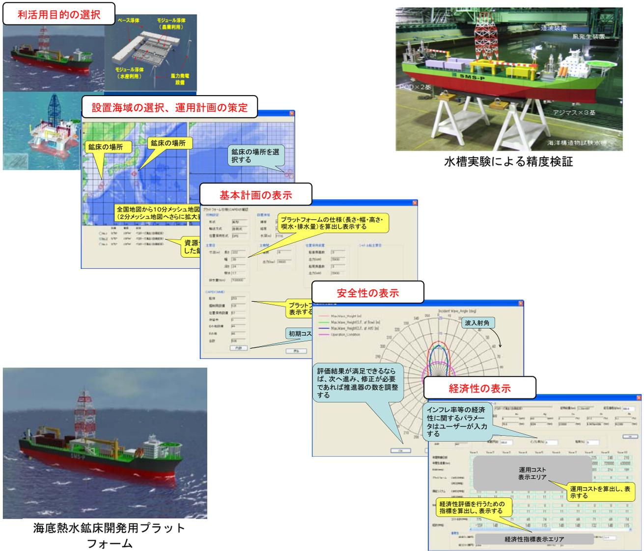
図5 調和設計プログラムの概略フローと表示画面(海底熱水鉱床開発用プラットフォームの例)
