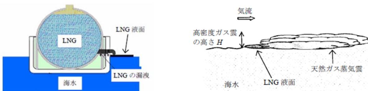
(a)液面拡大過程 (b)LNG 蒸発ガスの大気拡散過程
