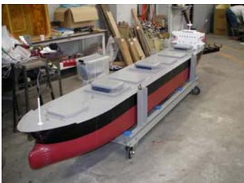
写真 3：ばら積み船模型
