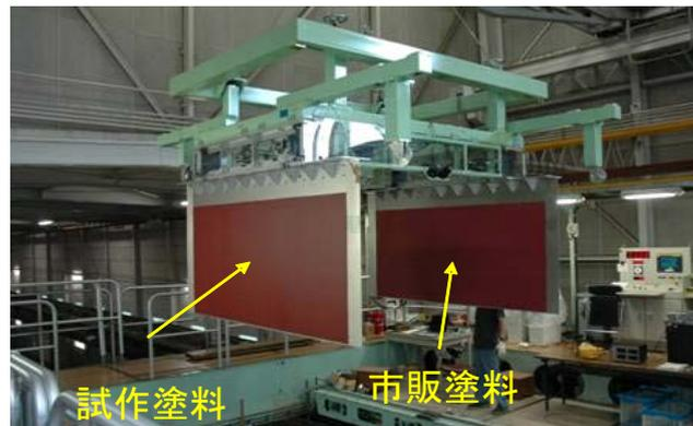
図2 市販塗料と試作塗料の摩擦抵抗の差を0.5%の精度で計測可能な高精度摩擦抵抗計測装置
