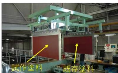
高精度摩擦抵抗計測装置
