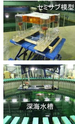
図1 水深5000m、5kt強潮流下での係留ラインの設計・安全性評価手法の開発
