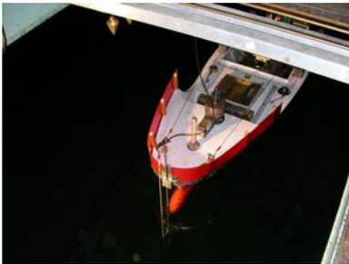
写真 1：中水槽における追波状態中流体力の計測実験。
