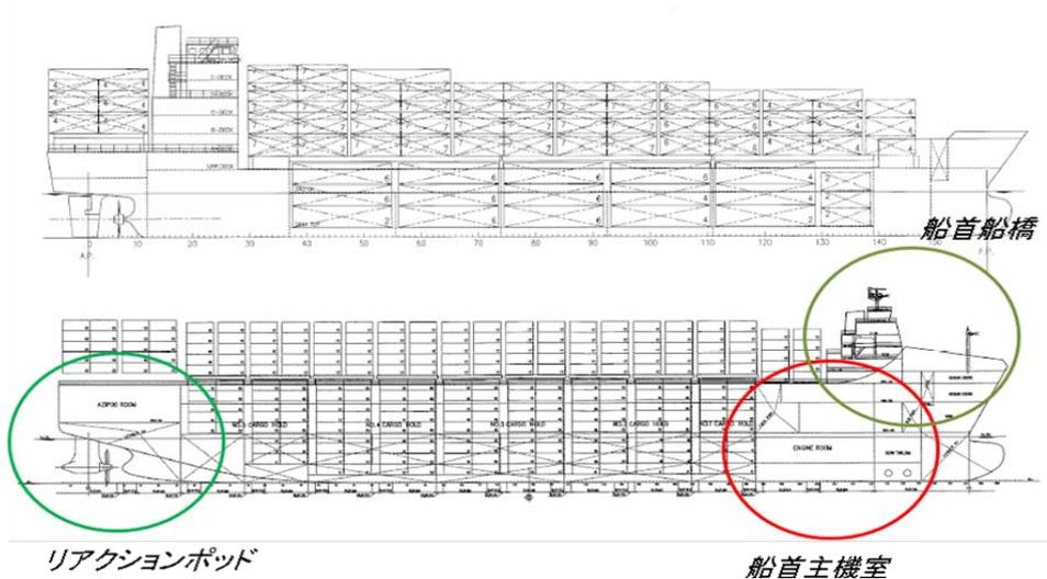
図3 従来型コンテナ船と超幅広2軸船の比較
