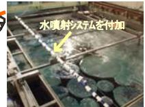
水中流出油回収装置の改良
