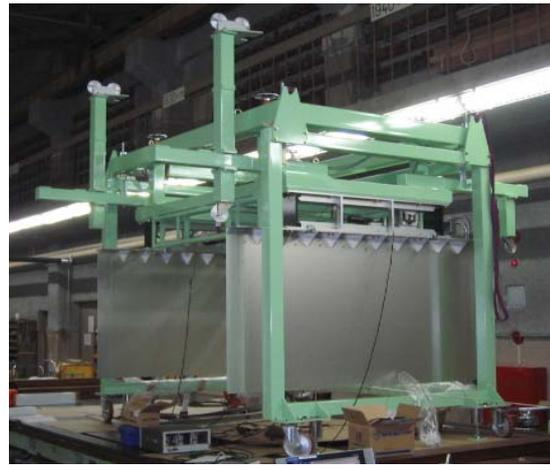
図2 高精度塗膜摩擦抵抗計測装置
