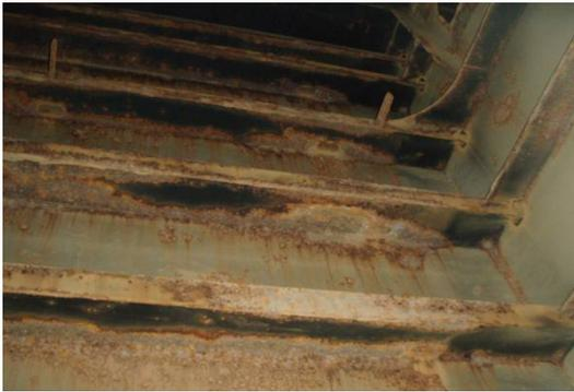
写真 二重船側内の著しい発錆の様子
