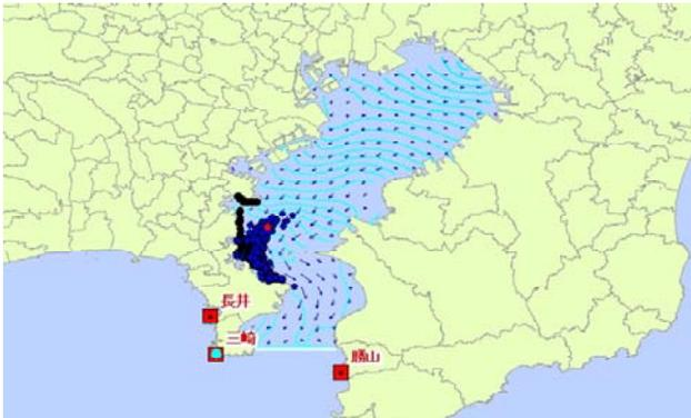
図 1 東京湾海上に A 重油 100t が流出した場合の 24 時間後の流出油計算結果例（海表面の油を●、海中の油を●で表示。水色の線は水温等高線）
