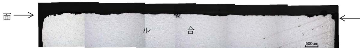
図3 人工海水で腐食させた押出材の断面
