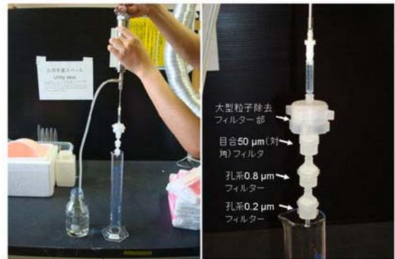
全量:ポンプ式注射器をストロークさせ、任意の量の水をろ過する。濾過量はストローク回数、もしくはろ液の量の測定による。
