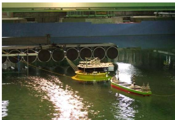
図-3 DP オペレーション検証試験の様子
