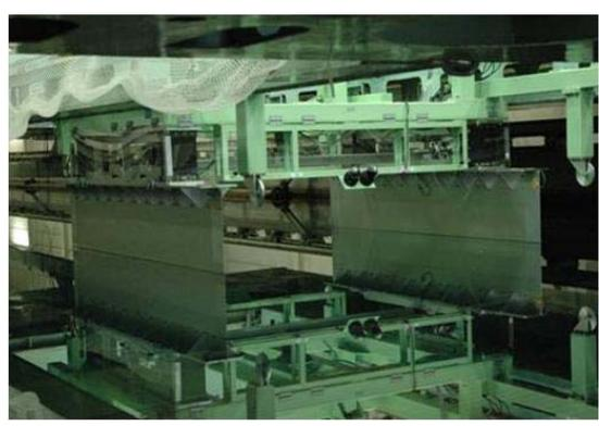
図3 高精度塗膜摩擦抵抗計測装置の
