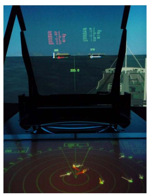
図 3 目視認識支援装置の情報表示の様子
