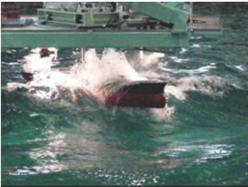
図 3 実海域を模擬した多方向不規則波中三角波に遭遇するばら積み船模型(実海域再現水槽, 合成波信号による造波, 任意データモードと波力測定装置, 一元制御システムによる模型船曳航。)
