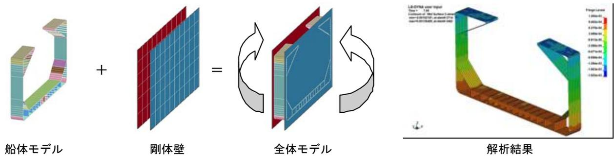
図 3 船体桁の逐次崩壊解析例
