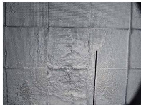
(b) 約 2200 時間 SCR 運転後の触媒表面
