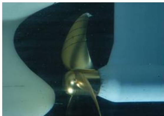
図5 大直径3翼プロペラのキャビテーション試験結果
