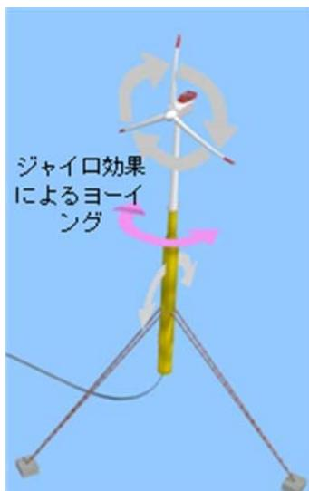
スパ-浮体式風力発電システム
