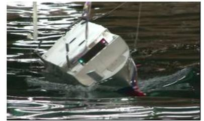
図 5 高速フェリーの追い波中大傾斜事故の再現(大傾斜とこれに伴う荷崩れ、これに続く左急旋回を再現している。右舷青ランプは荷崩れ発生、左舷赤ランプは横傾斜角 30 度以上を表す。)
