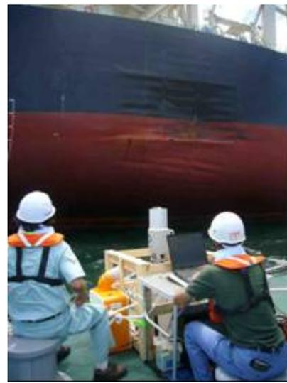
図 6 船上からの船体形状計測
