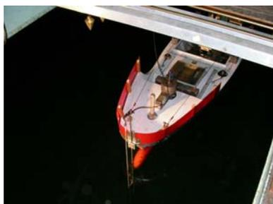
写真 2：中水槽における追波状態中流体力の計測実験。
