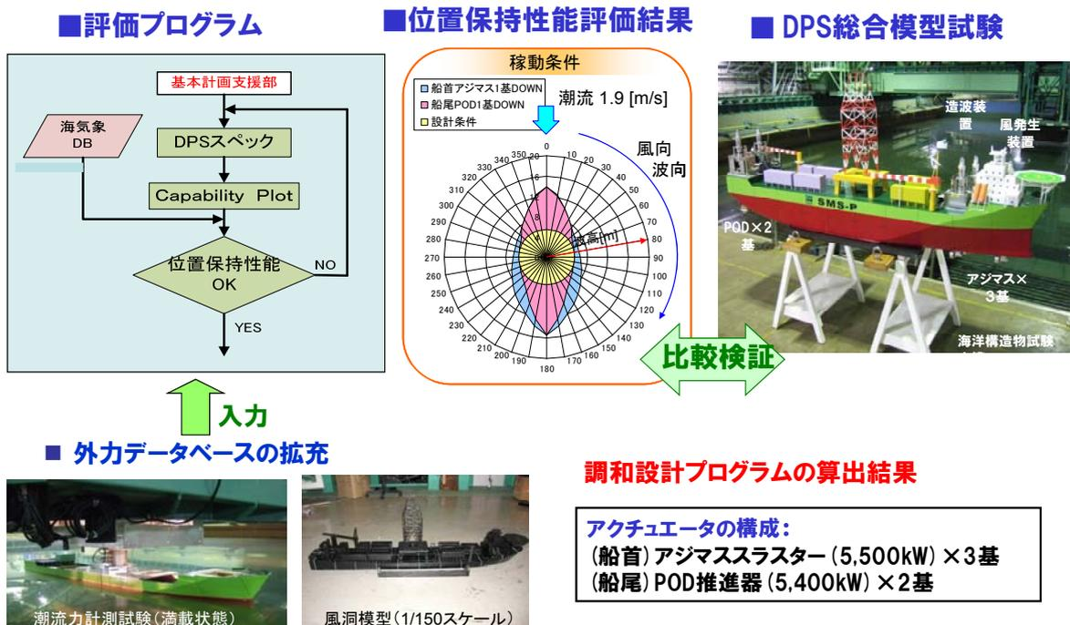
図2 5kt強潮流下でのDPシステムのアクチュエーターサイジング手法と安全性評価手法の開発
