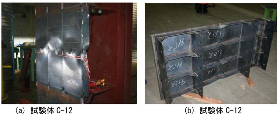
Fig. 3 腐食防撓板の座屈・崩壊試験結果
