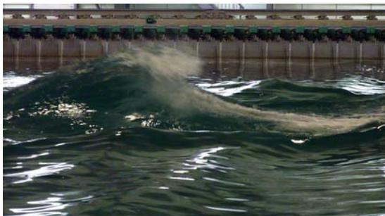
写真 1：実海域再現水槽における不規則波中の大波高波の造波実験写真。吸収型任意造波法による造波。
