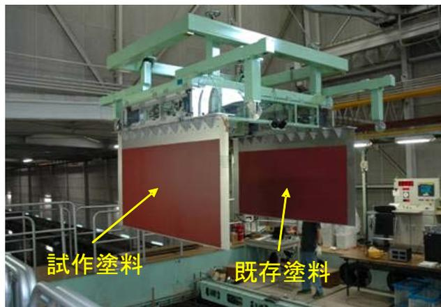
図2 市販塗料と試作塗料の摩擦抵抗の差を0.5%の精度で計測可能な高精度摩擦抵抗計測装置
