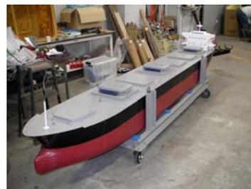
写真 4：ばら積み船模型
