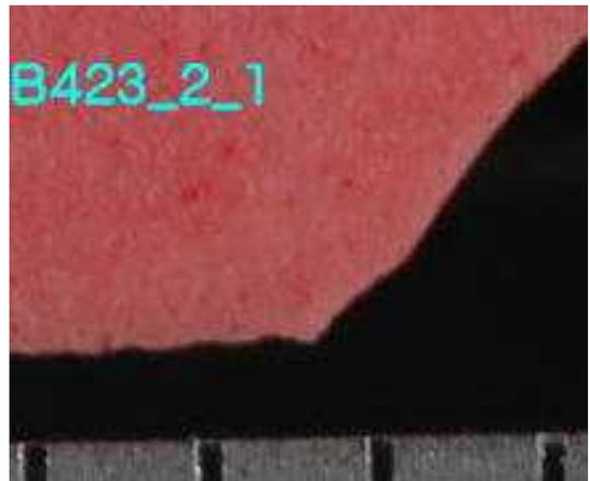
印象剤を用いて計測した溶接止端形状
