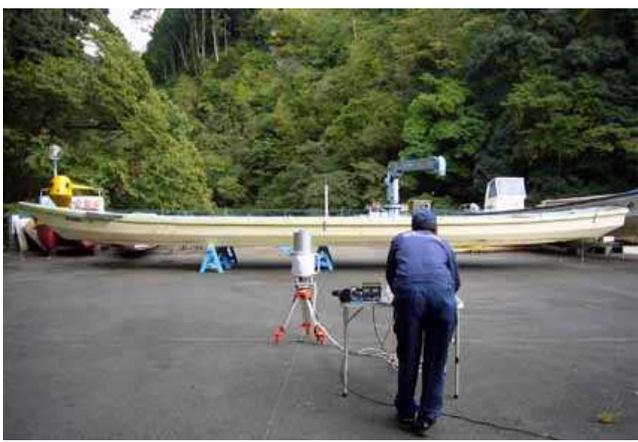
写真 1 船体形状データ計測作業（川船）
