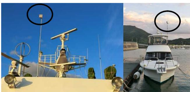
無線 LAN 通信実験を行った船舶のアンテナ設置状況
