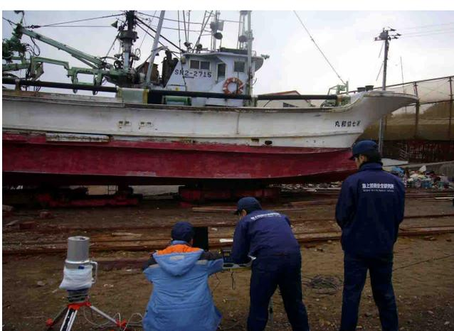
写真 2 船体形状データ計測作業（漁船）
