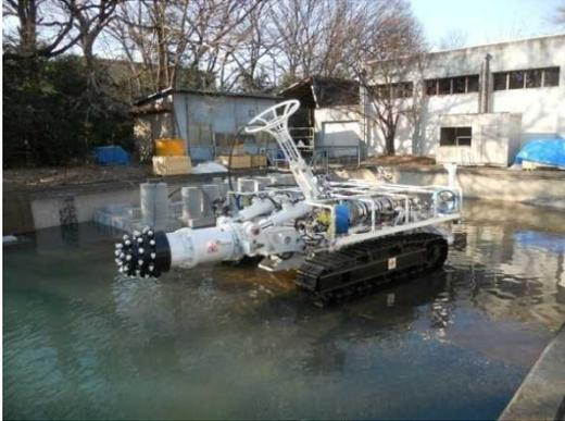
(b) 水中での掘削試験の様子
