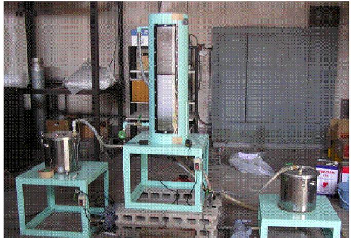
油処理剤の水中散布実験装置
