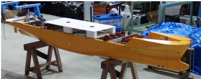
水槽試験に用いたコンテナ船模型
