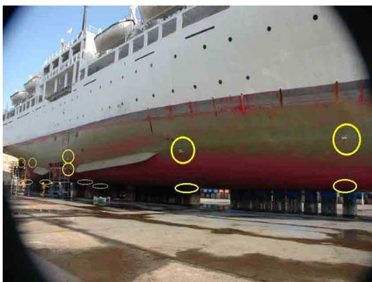
図4 防汚剤の溶出速度の計測箇所 (青雲丸、12箇所)
