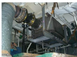
実船補機に搭載された試験用触媒システム
