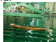
実海域再現水槽 における斜波中 の抵抗増加試験
