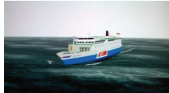
フェリーありあけの 船体運動の様子 (操船リスクシミュレータ)
