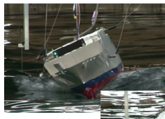
実海域再現水槽における フェリーありあけの 船体傾斜に至る過程の検証
