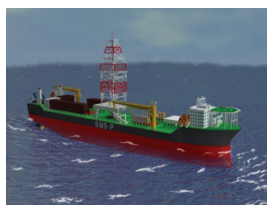
海底熱水鉱床開発用 船型プラットフォームの例
