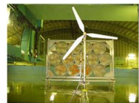
水槽試験による挙動確認
