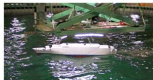
自動追尾カメラにて計測中の模型実験
