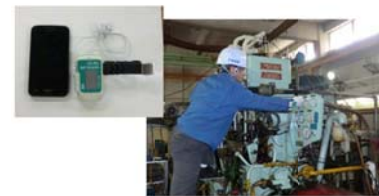
機関点検支援システムのヒューマンインターフェイス部及びこれを使った点検作業の様子
