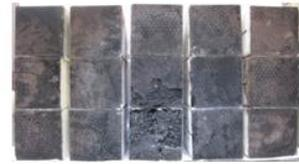
10,000時間試験後の触媒。排ガス入り口側(上流側)の写真
