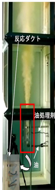
図3 広口円筒状の反応ダクト(赤枠で表示)内で浮上油に対して油処理剤を噴射する様子
