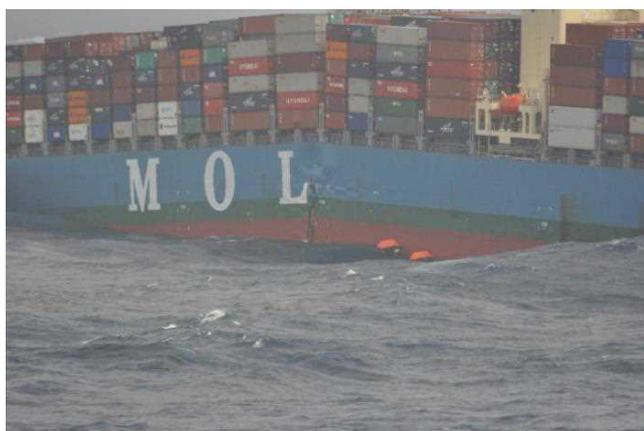
図1. 1. 8 事故時の事故船の状態（亀裂の進展方向（商船三井提供））
