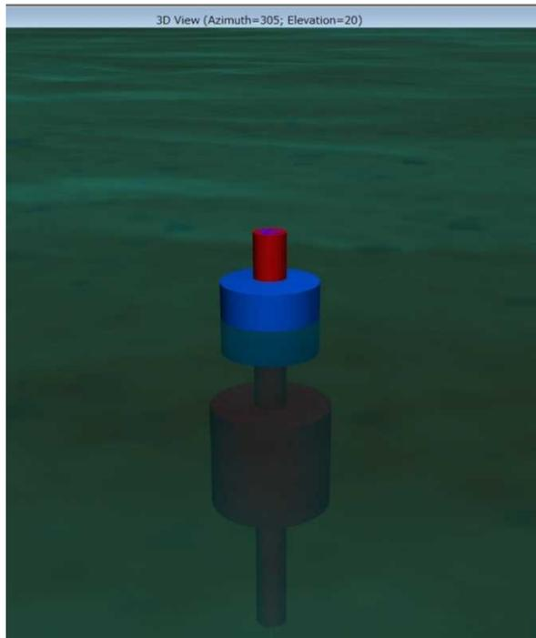
図8 シミュレーションモデル（並進動揺型：フロートが動く）
