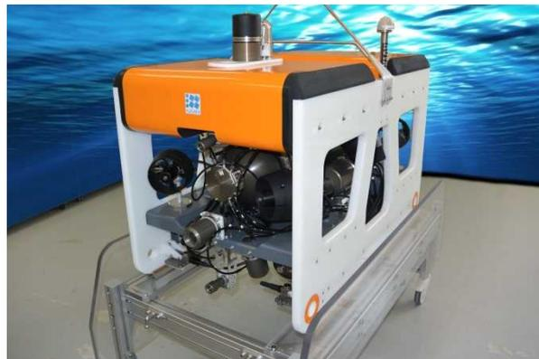
開発・製作したホバリング型 AUV
