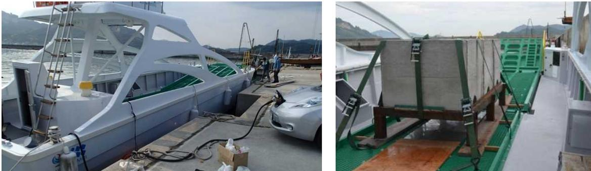
図 1 シームレス小型船システムの EV 充放電システムの試験状況（左図）と小型バスと同重量の重りでの海上試運転状況（右図）
