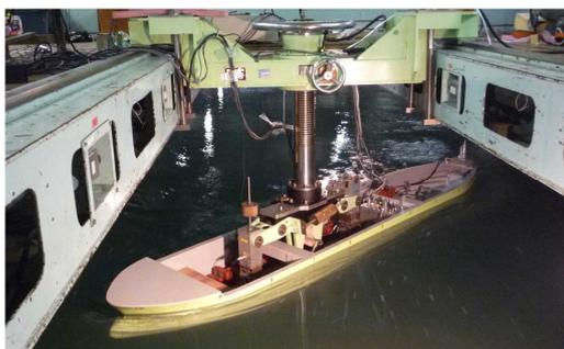
図1 高プロペラ荷重度・大斜航状態での流体力計測実験
