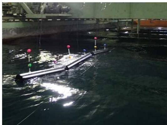
図7 模型概観および水槽実験状況（屈曲動揺型）
