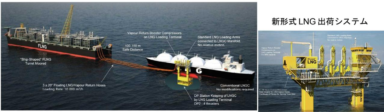
参考図 1 新形式 LNG 出荷システムを用いた洋上 LNG 移送形態 (出典 : OTC-25980-MS)
