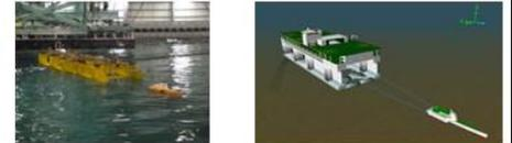
ロジスティックハブに対する高速船の着積システム評価
