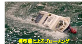
模型船によるブローチング
