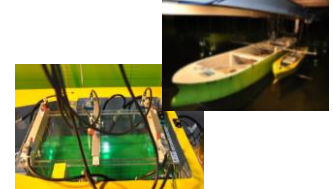
LNGタンク液面変化を考慮した2船体動揺試験
