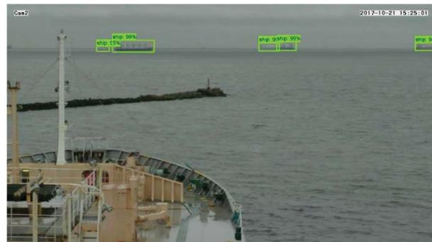
図4 右舷のカメラと他船検出結果
