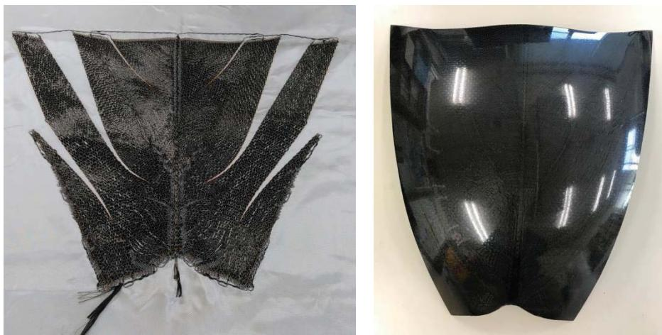
図2 自動車ボンネット曲面に対する提案手法での CFRP 成形物
