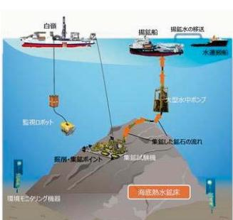
採鉱・揚鉱パイロット試験概念図(左)及び洋上に揚がった鉱石(右)
