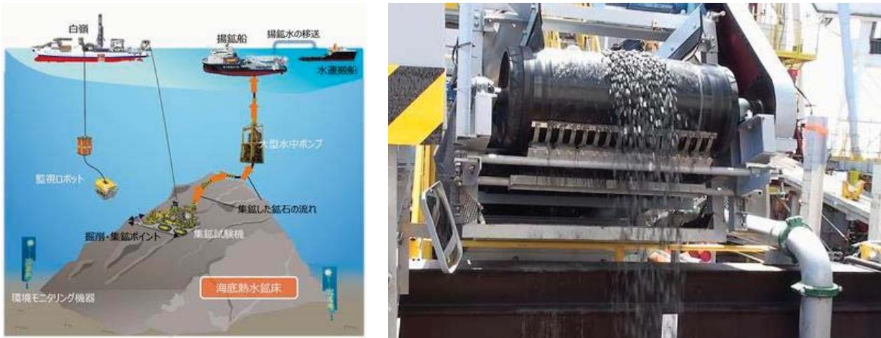
図 5 採鉱・揚鉱パイロット試験概要（左）及び洋上に揚がった鉱石（右）（経済産業省 HP より）
