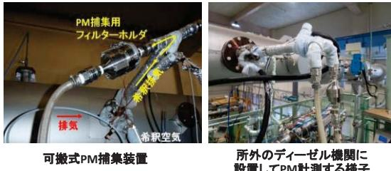
○エンジンの運転条件によるBC・PM排出削減効果の評価を行い、エンジンの燃料噴射圧を上げることにより60~77%のBC削減効果、2~3割のPM削減効果を確認した。
