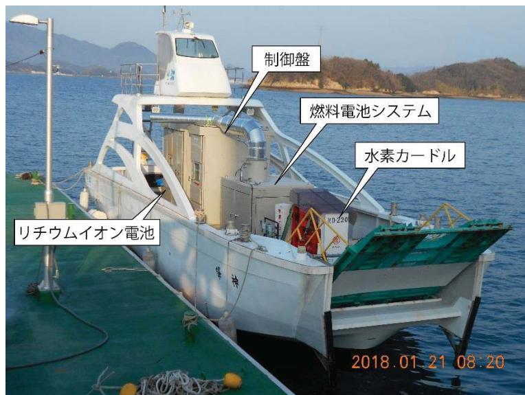
図2 水素燃料電池システムおよびリチウムイオン電池を搭載した小型実験船
