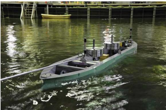
図1 潮流中の振れまわり挙動計測試験
