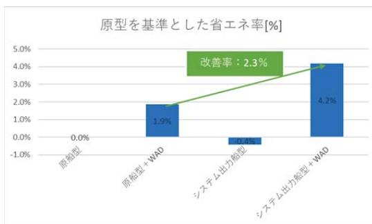
図 1 伴流設計システムを用いた船型改善による省エネ効果（水槽試験結果）
