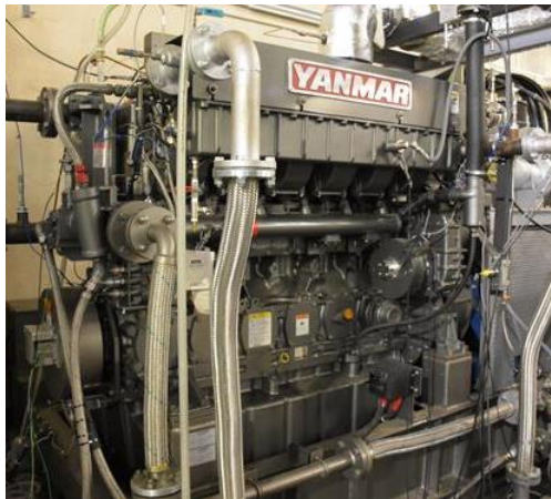
図4 実験用 400kW ガスエンジン
