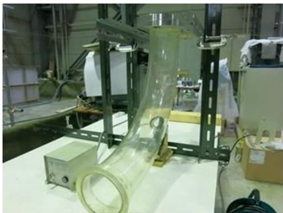
図10 磁性ビーズ吸着試験装置
