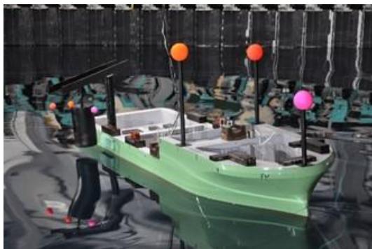
横吊状態での波浪中動揺試験
