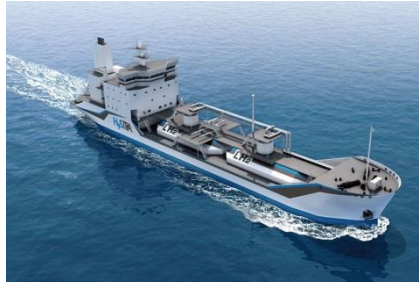
図8 液化水素運搬船（2020年に建造する予定のPilot船）の実船モデル （イメージ図（HySTRAより））
