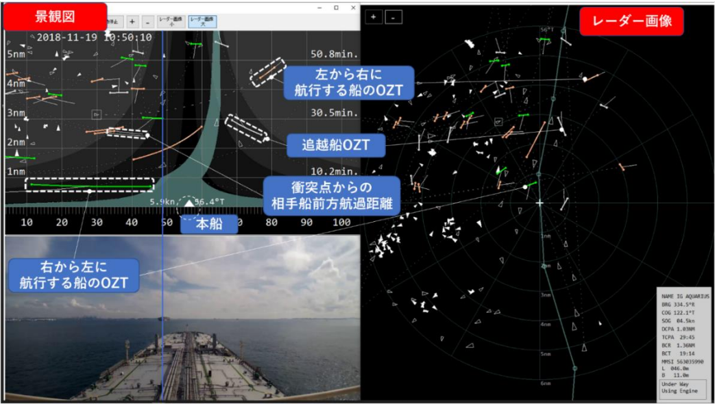
図 7 OZT の見える化による避航操船判断支援システムの画面
