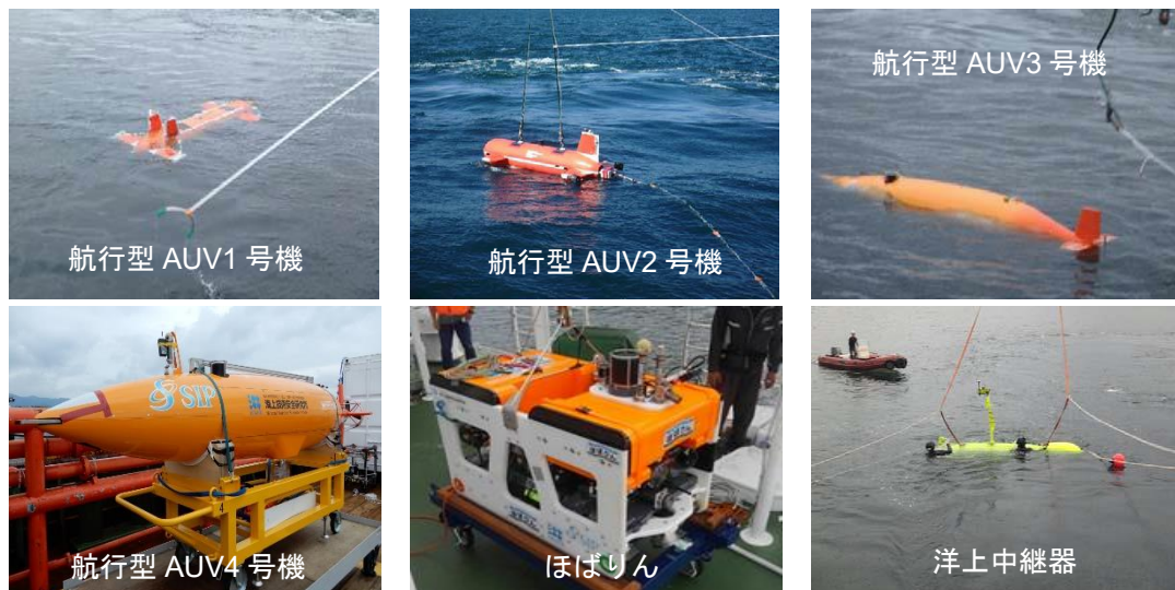
図 1-1 航行型 AUV1~4 号機、ホバリング型 AUV「ほぼりん」、および洋上中継器
