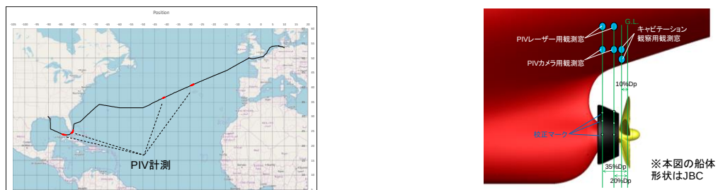
図19 実船計測海域とPIV計測断面
