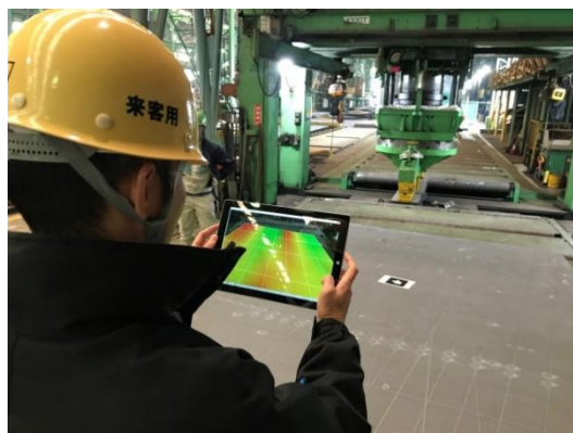
図 1 実際の造船所における「曲げ加工支援 AR システム」の検証
