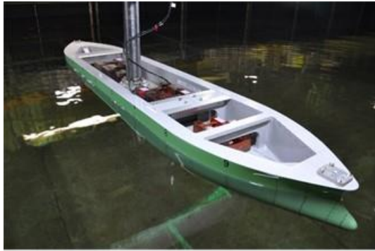
図 20 浅水域における拘束曳航試験の様子（左図）と横力の無次元係数（右図）
