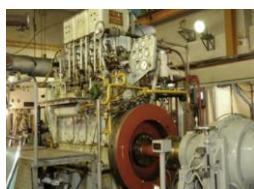
燃焼試験に用いた船用エンジン
