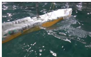
縦曲げ・振り剛性相似模型による水槽実験と模型船の設計に用いたFE固有値解析
