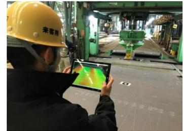
実際の造船所における「曲げ加工支援ARシステム」の検証
