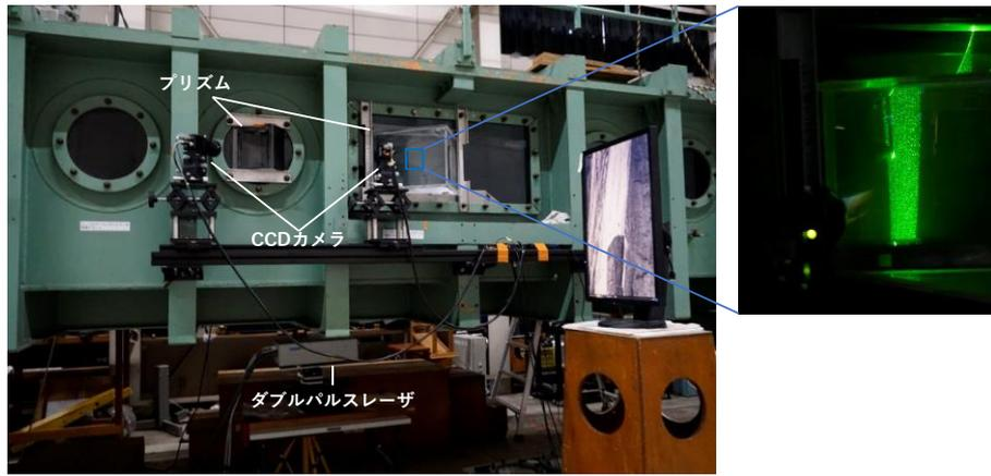
図 13 大型キャビテーション水槽 PIV 計測システム
