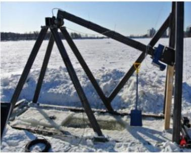
図 11-1 氷塊-鉄球衝突実験
