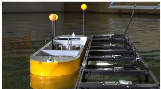
図 19 パースに係留された船舶の波浪中動揺試験
