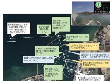
着棧支援システムの音声ガイダンスの例 操船シミュレータによる着棧実験
