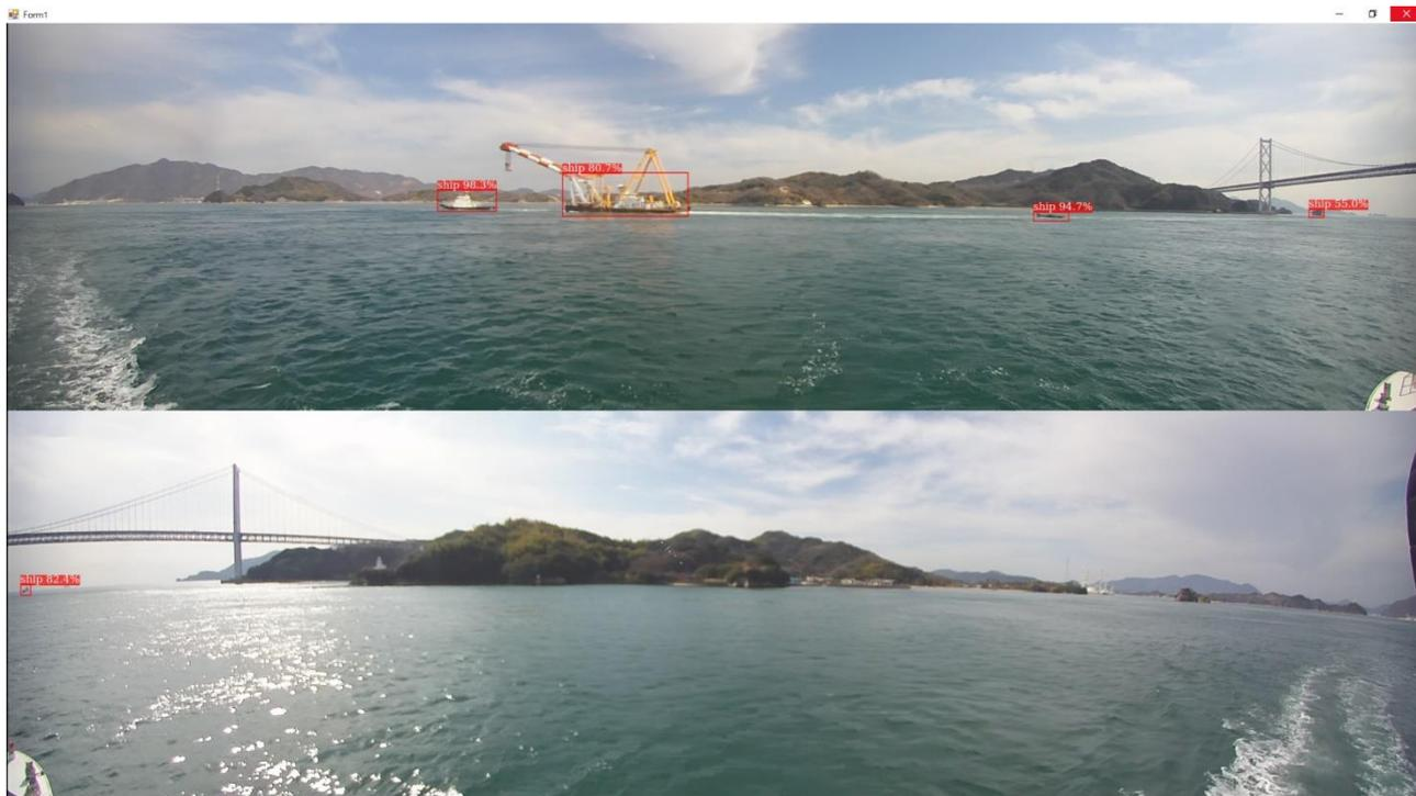
図 2-4 全方位他船監視システム検出試験結果
