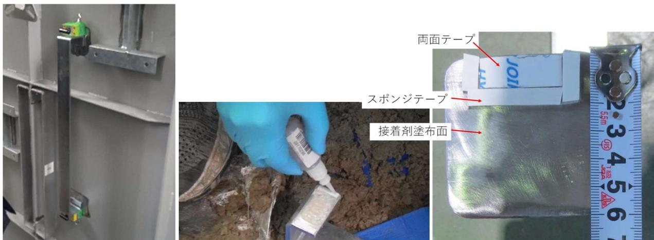
図2 マグネット、瞬間接着剤、両面テープによる仮止め方法
