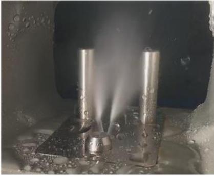
図 3-1 シリンダ吸気への水噴射の様子
