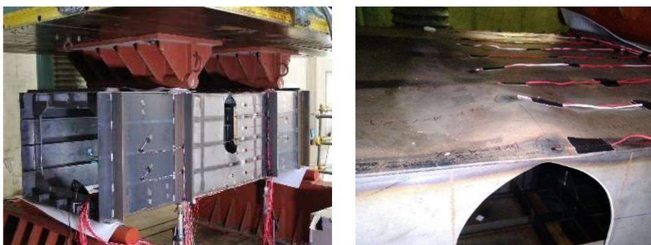
図1-④-2 損傷あり箱桁構造模型の4点曲げ崩壊実験の様子
