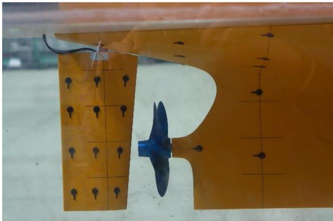
図7 プロペラ付近船尾と模型舵に貼付した FBG 圧力センサー
