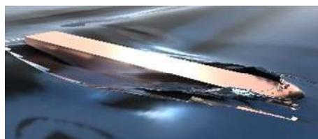
図 1-②-2 船体荷重評価のための NAGISA 格子分割及び結果
