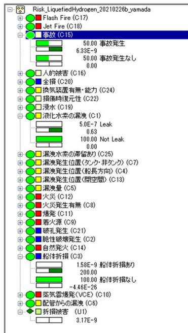
図 2-2 ベイジアンネットワークを用いたリスク一覧表示例
