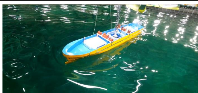
図 3-1 コンテナ船不規則中パラメトリック横揺れ試験
