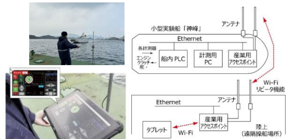
タブレットによる操作及びWi-Fi機器、試験装置の構成
