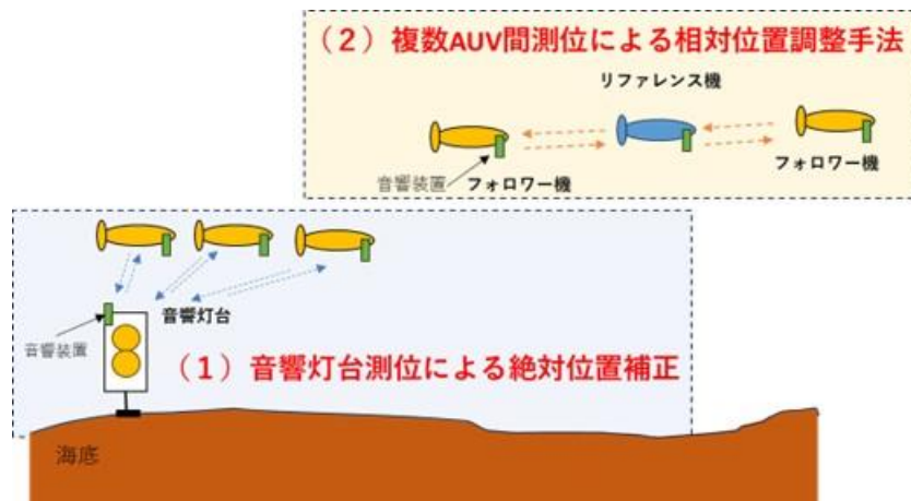
図 3-2 リファレンス - フォロワー群制御の基本概念
