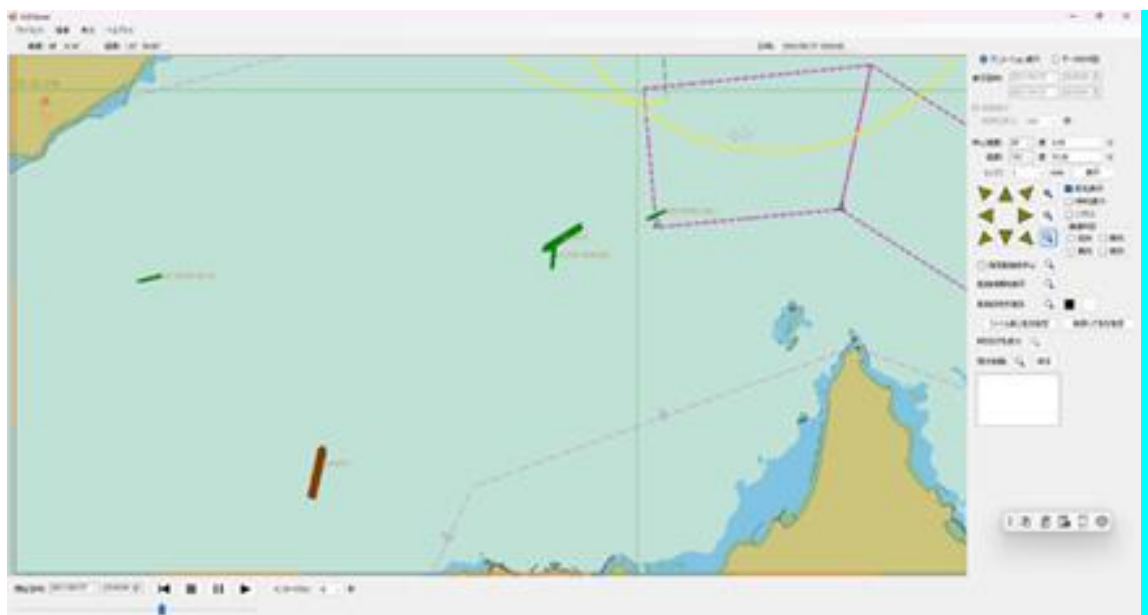
図 5-11 AISViewer による衝突事故時の船型表示例(来島海峡航路西側海域で 2021/5/27 23:53 頃発生)
