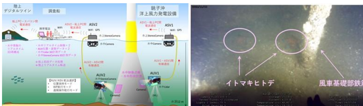
図 3-10 銚子沖洋上風力発電設備の海中部点検技術試験概要図と試験から得られた海底映像
