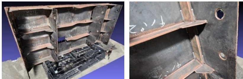
全体 右端部の拡大 図 1-1 試験体サイズ(2m程度)での3D 形状生成結果
