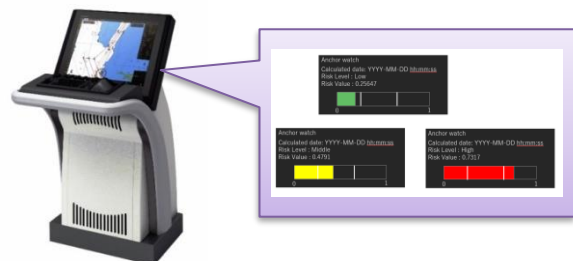
図 4-3 振れ回り運動の数値シミュレーション 結果を ECDIS 上に表示する画面
