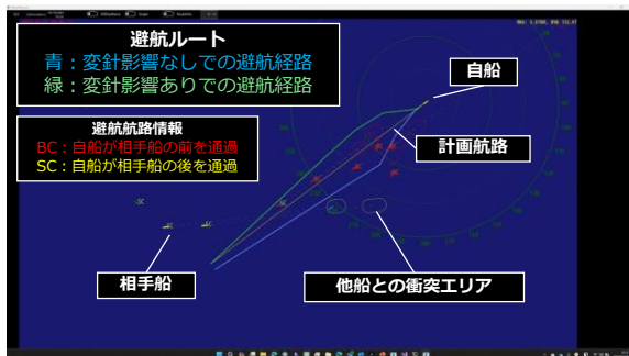
避航操船システム(シミュレーション画面)
