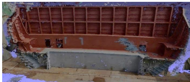
図 1-3 実船スケールの3D 形状生成結果
