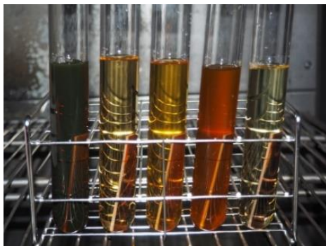
図 5-2 各種バイオ燃料(金属腐食試験)
