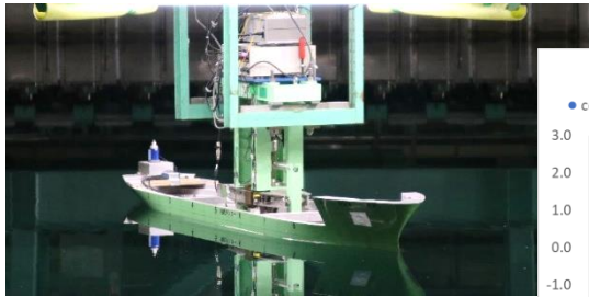
図 4-1 内航タンカー模型 の操縦流体力の計
