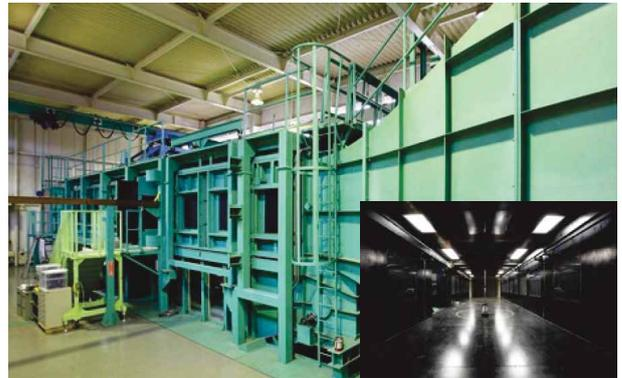
風洞計測部: 長さ 15m × 幅 3m × 高さ 2m
