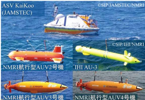
海技研が開発した基本隊列制御で実現した異機種AUV 4機とASV 1機(左)の同時運用による高精度・高効率の海底調査(右)
