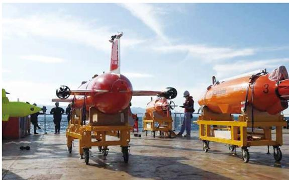
複数AUV同時運用実海域試験の様子
