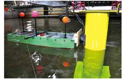
洋上風力発電アクセス船の乗り移り性能評価試験
