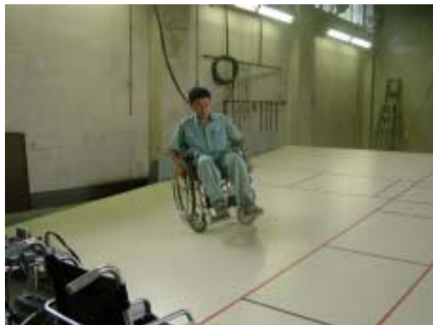
図-2 船内を想定した傾斜台上の走行実験
