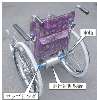
図-3 走行補助装置を取り付けた手動車いす
