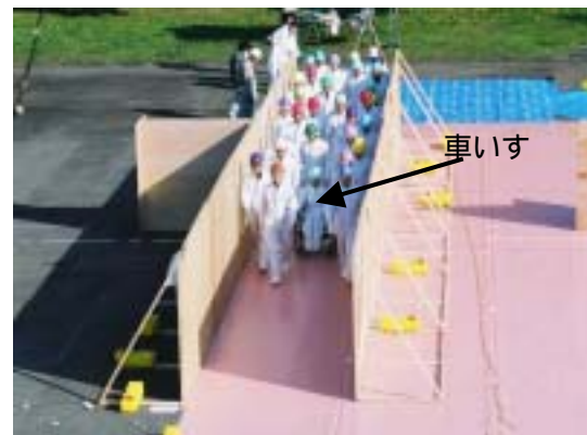
写真2 通路幅2mでの実験
