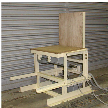
図 9 試作した介助用車いすの駆動機構 (Type A)
