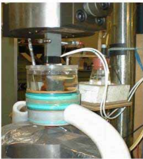
船体用材料の海水腐食疲労試験
