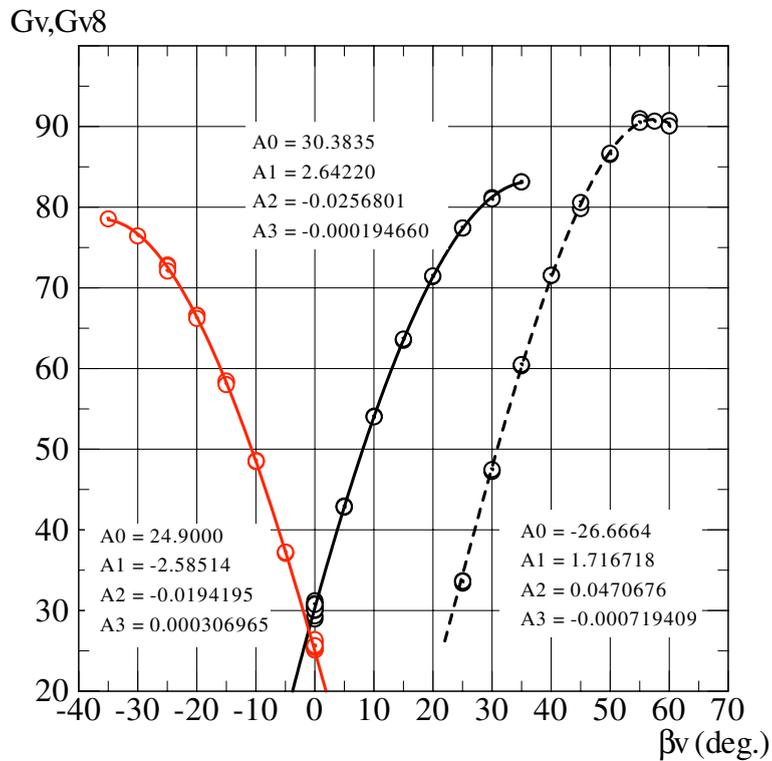
(d) Correlation Curves of G<sub>v</sub> and G<sub>v8</sub> versus Vertical Flow Angle  $\beta_v$
