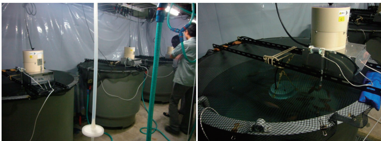
図 4.1 暗幕内の水槽設置状況（左）と水槽内のスピーカー設置状況（右）
