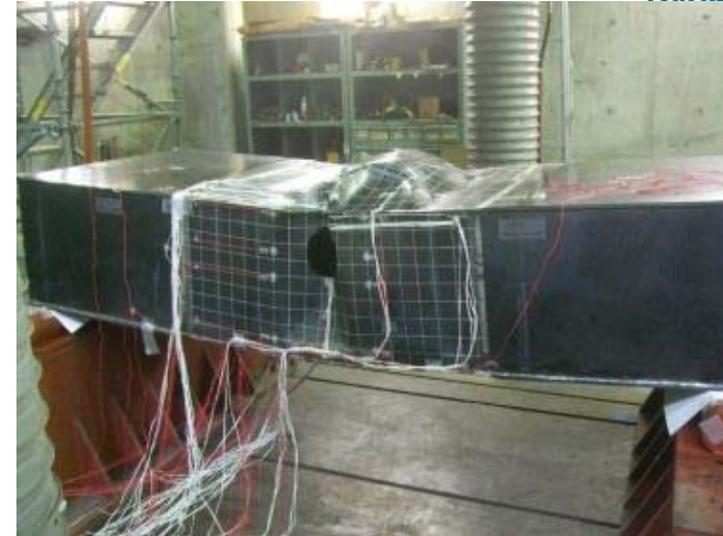
衝突損傷を想定したハルガーダ一船舶模型の4点曲げ試験
