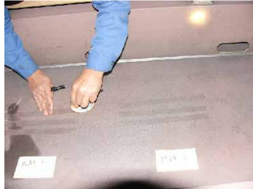
図2 床塗装面のゴミの測定
