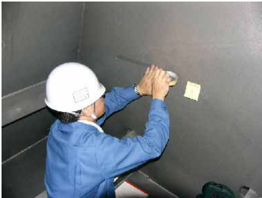
図1 側壁塗装面のゴミの測定
