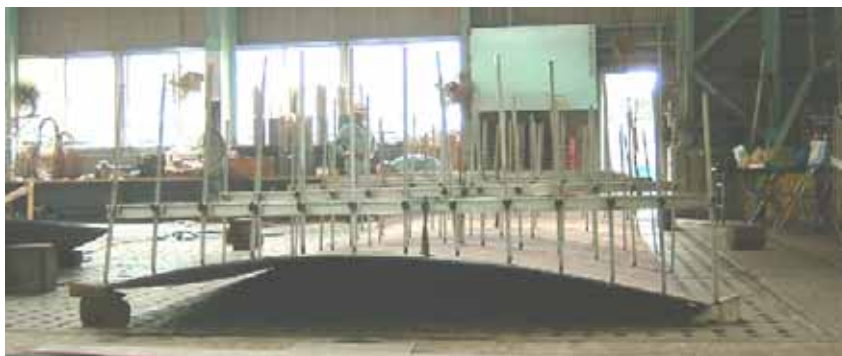
図 5.12 加工後の板の見透し
