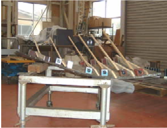
図 5.9 木型縦板の向きの様子
