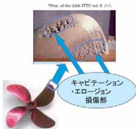
図4 キャビテーション・エロージョンにより損傷したプロペラ先端部の例
