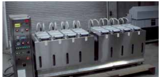
図4 バラスタタンク環境再現試験装置
