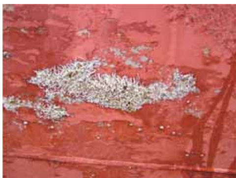
図1 船底への生物付着の例
