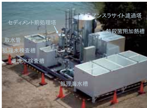
図2 アンスラサイトろ過型バラスト水浄化実験装置
