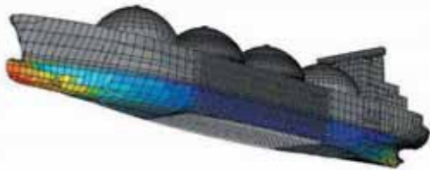
全船FEM model（水圧荷重を作用時）
