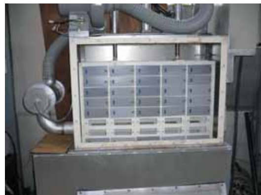
図5 薬剤のバラストタンク塗装影響試験
