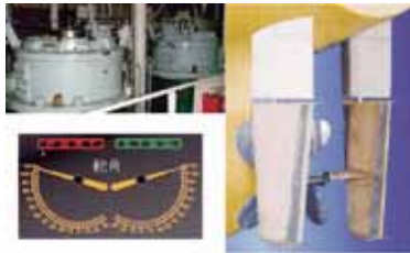
図6 ロータリーベーン操舵装置と2枚舵
