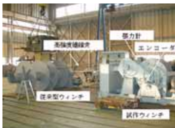
写真3 ウインチ制御の陸上試験状況
