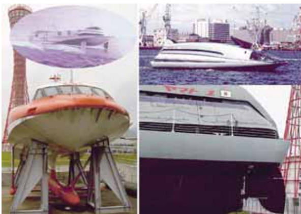
図3 テクノスーパーライナー実験船疾風(左)と超電導電磁推進実験船ヤマト1(右)
