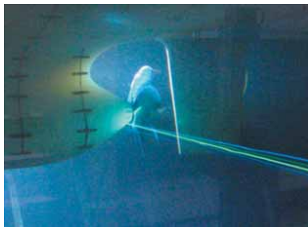
LDVによるプロペラ周囲流場の計測
