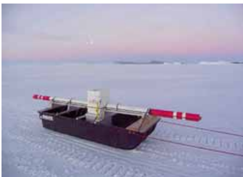
図-8 そり牽引型氷厚観測システムIce Worm。EMセンサ(EM31mk2、Geonics製)は風雪や雪面との接触による損傷を防ぐためにFRP製のケーシングに納め、FRP製のポートに着脱可能のように搭載してあります。第47次越冬隊撮影。
