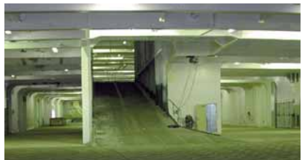
船尾からスロープウェイを見る。シャーシの通り抜けは容易。スロープ下部は機関室
