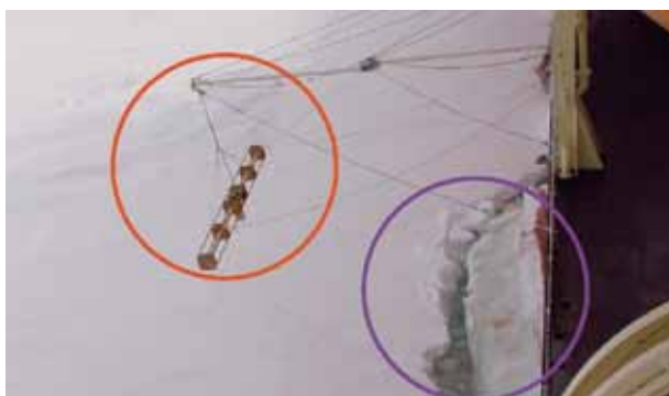
図 - 2 電磁誘導センサー（赤丸）と氷盤断面（青丸）。EM法では積雪と海水を区別して計測できないのでビデオから積雪深を計測します。
