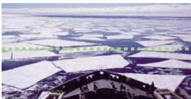
図 - 3 船首前方画像。点線上の氷と海水の割合から氷密接度を算出します。
