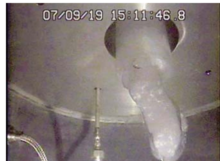
図3 二重管構造ノズル(アクリル製)から高圧水中にCO 2 スラリーを投入する様子(温度7℃、圧力5MPa)(CO 2 スラリー押し出し流量86mL/sec)
