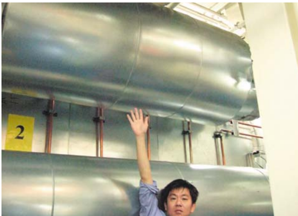
北欧旅客フェリーのエンジンルームの還元剤装置（当PT村岡研究員）
