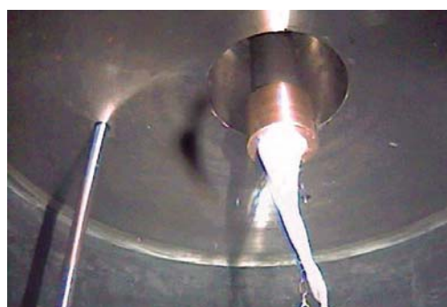
図1 試作ノズル（真ちゅう製）から高圧水中にCO 2 スラリーを投入する様子（温度4℃、圧力5MPa [水深500mに相当]）
