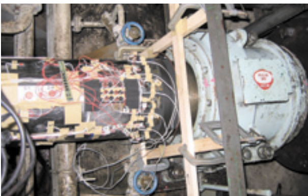
図-3 プロペラ軸にひずみゲージを貼り付けているところ（左側が船尾、右側がエンジン側です）
